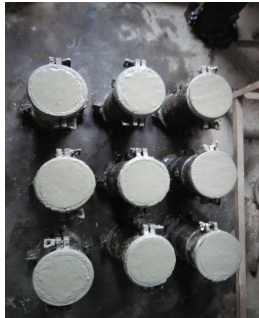
Pencetakan Beton Silinder
