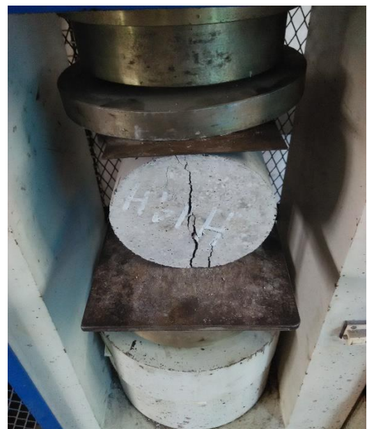
Beton Hasil Uji Tarik Belah
