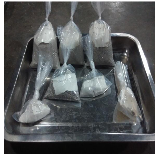
Hasil Uji Gradasi Pasir
