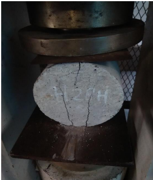
Beton Hasil Uji Tarik Belah
