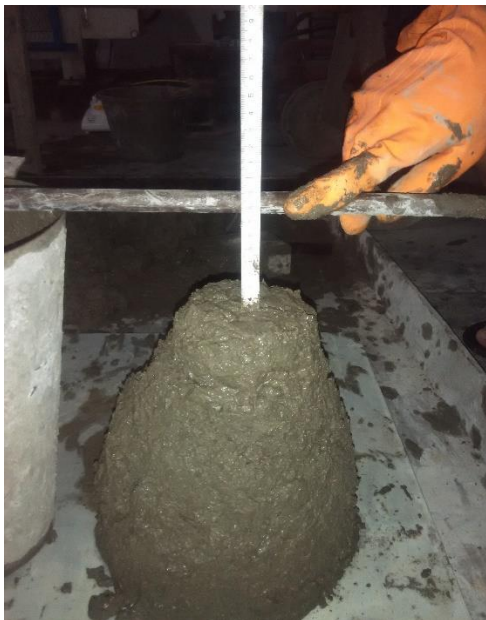
Pengujian slump test
