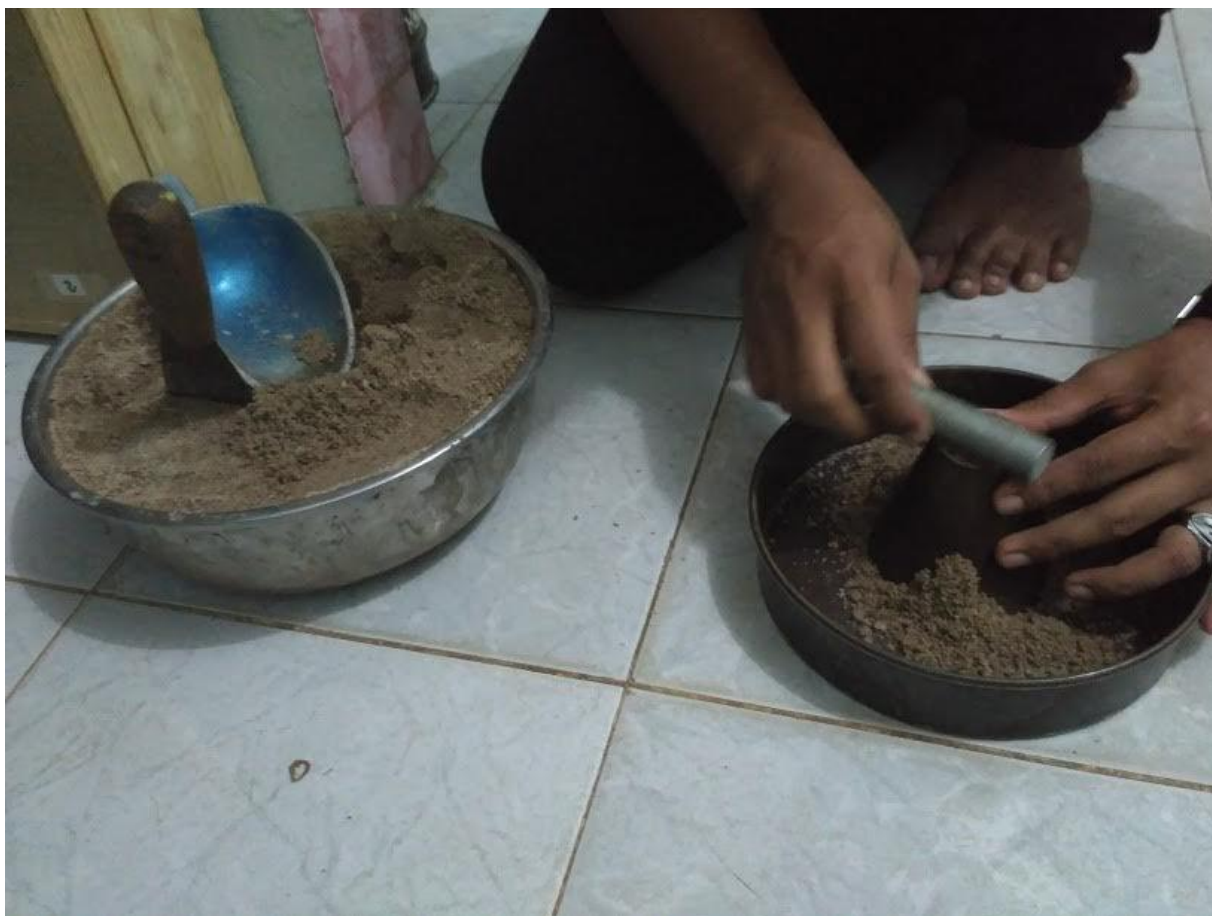
Pengujian pasir dengan kerucut
