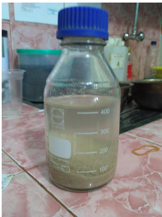
Pengujian Kandungan organik pada pasir
