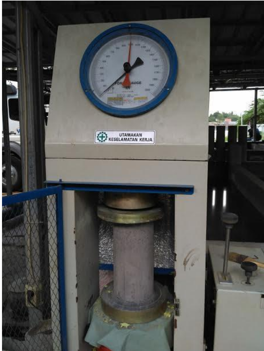
Pengujian Sampel Beton
