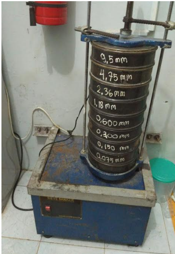
Pengujian gradasi kerikil dengan ayakan
