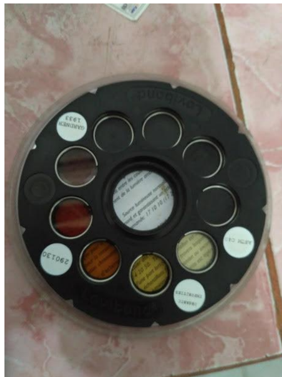
Pengujian Kandungan organik pada pasir
