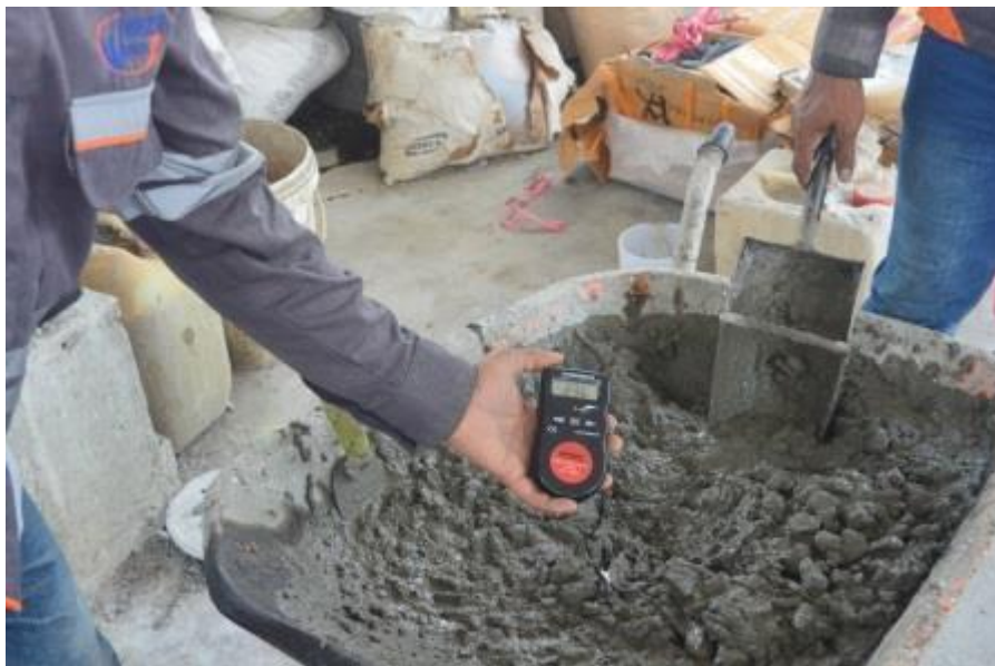
Pengukuran suhu pada beton
