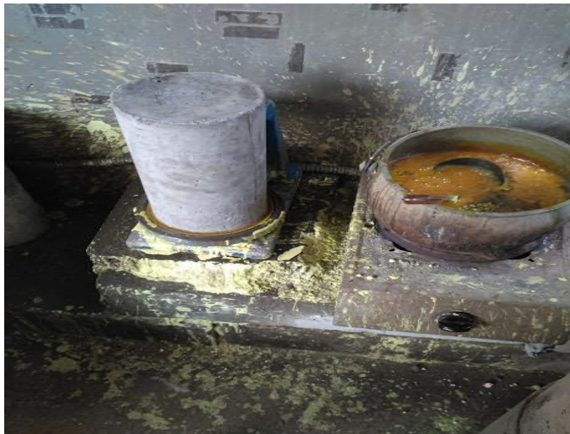
Pemasangan kaping sebelum pengujian kuat tekan beton
