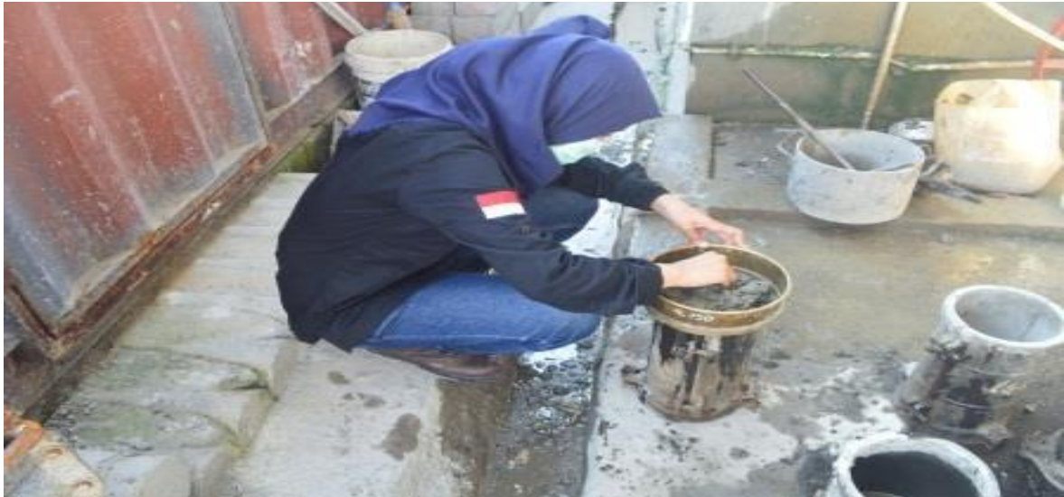
Pengayakan beton segar dengan ayakan 4,75 mm untuk setting time
