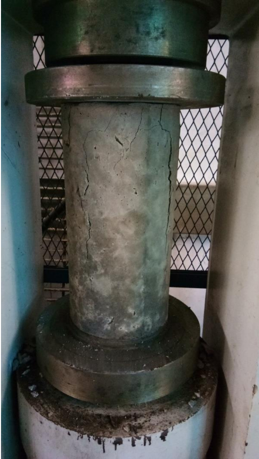
Proses Pengujian Kuat Tekan Beton
