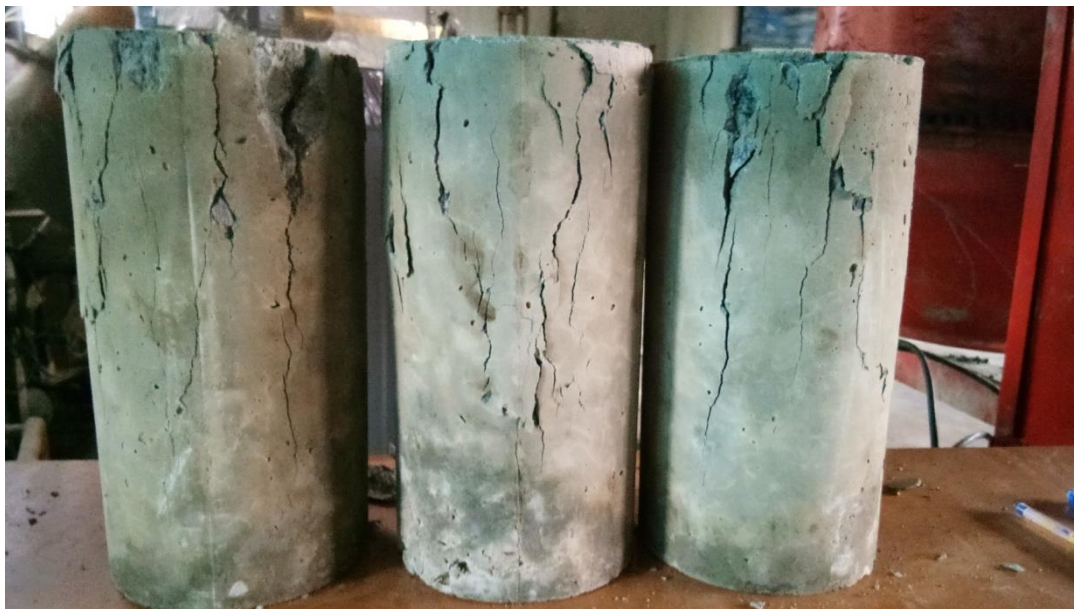
Retakan Sampel Hasil Uji Kuat Tekan
