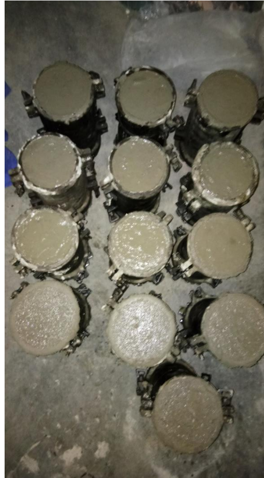
Hasil Penuangan Beton Segar Ke Dalam Cetakan Silinder (15 cm x 30 cm)
