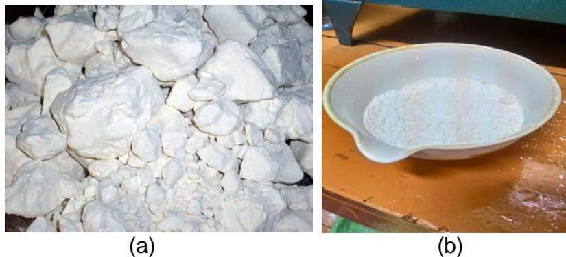
Gambar 2.2 Bongkahan kaolin (a), Kaolin bubuk (b)
