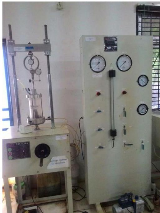
Gambar 2.5 Alat uji Triaksial (sumber: *Laboratorium mekanika tanah jurusan teknik Sipil STT-PLN*)
