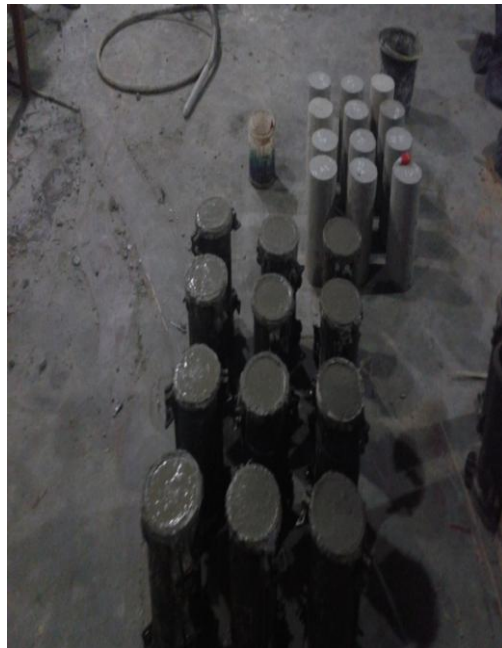
Pencetakan Beton Silinder
