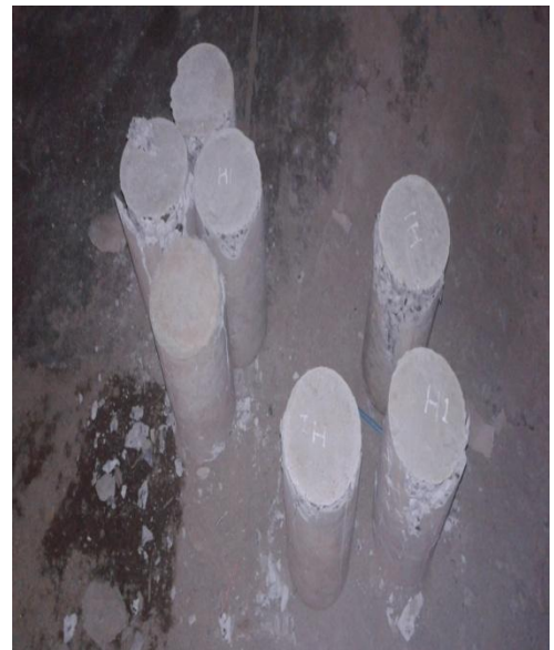
Beton Yang Sudah di Uji Tekan
