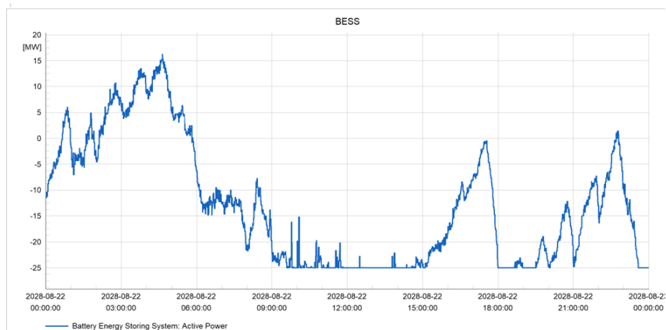
Gambar 4.33 Hasil Simulasi Quasi Dinamis untuk Output BESS 25 MW
