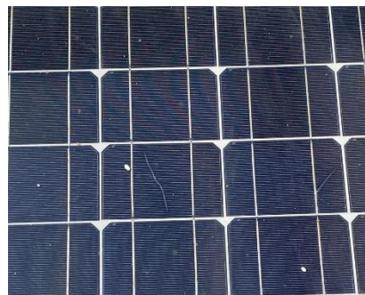
Gambar 2. 2 Permukaan modul surya dengan kerusakan elektrik / electrical damage
