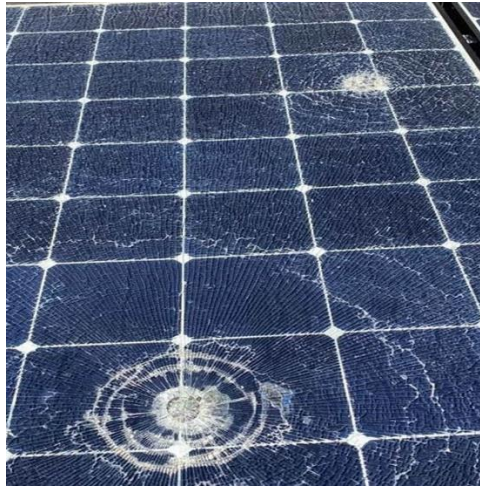
Gambar 2. 1 Permukaan modul surya dengan kerusakan fisik / physical damage
