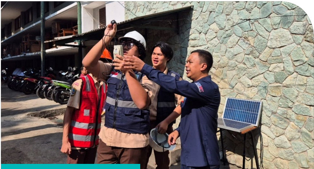
Gambar 18. Para murid secara bergantian mengukur radiasi matahari dengan menggunakan pyranometer
