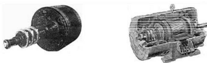
Gambar 2.3 Konstruksi motor tiga fasa rotor belitan
