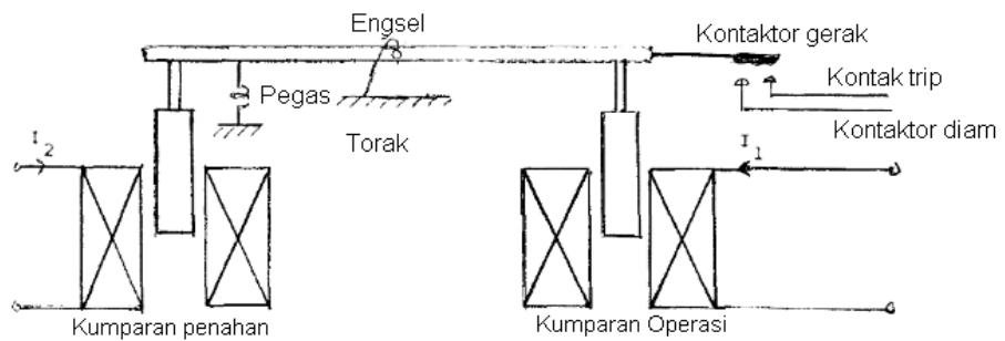
**Gambar 2.5.** Relai Elektromagnetik Tipe Batang Seimbang
