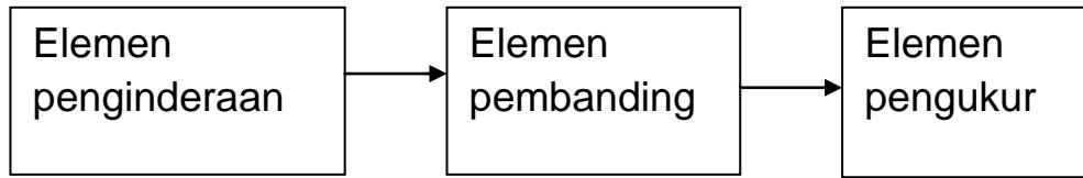
**Gambar 2.2** Diagram Blok Prinsip Kerja Relai Proteksi
