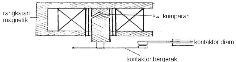
**Gambar 2.3.** Relai Elektromagnetik Tipe Plunger
