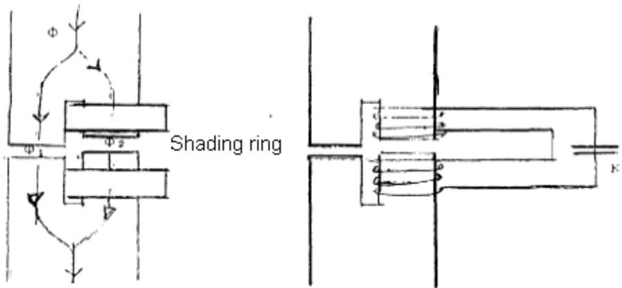
**Gambar 2.7.** Relai Induksi Menggunakan Metode Shaded Pole
