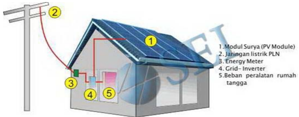
Gambar 2.11 Prinsip Kerja sistem PLTS On Grid
