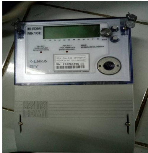
Gambar 2.3 KWh meter elektronik.
