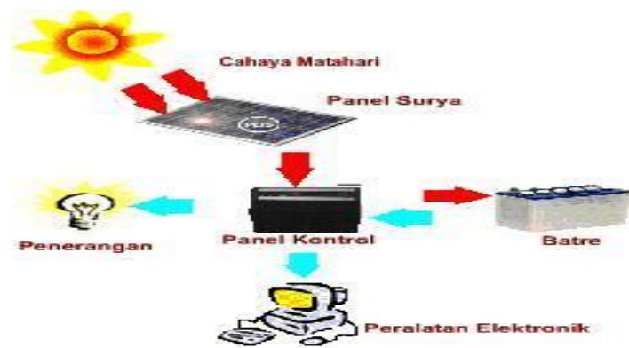
Gambar 2.6 Proses kerja PLTS
