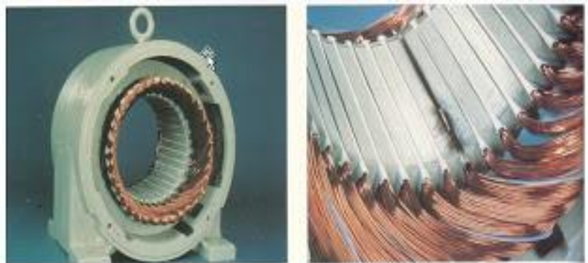
Gambar 2.15 Konstruksi stator dengan alur-alurnya
