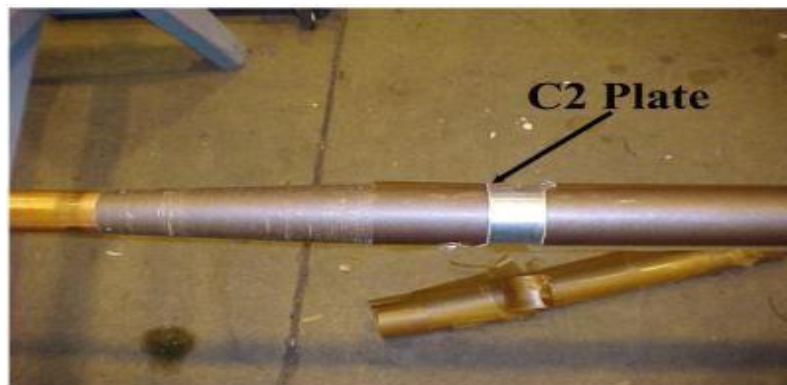
Gambar 2.7. Contoh kertas isolasi pada bushing ( oil impregnated paper bushing )
