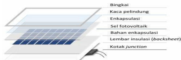
Gambar 2.4. Struktur Modul Fotovoltaic [8]
