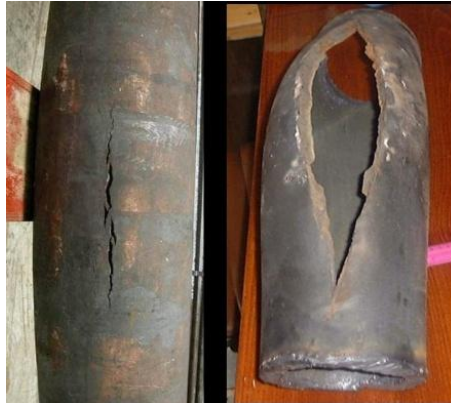
Gambar 2. 12 Proses Terjadinya Creep
