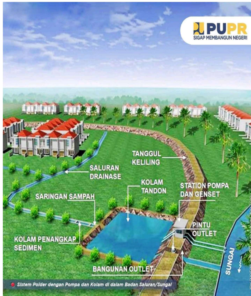
Gambar 2. 2 Kolam Retensi di dalam Badan sungai Sumber DPUPR
