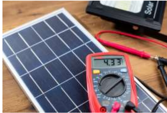
Gambar 2. 3 Pengukuran Suhu Dan Tegangan Pada Modul Panel Surya Mini
