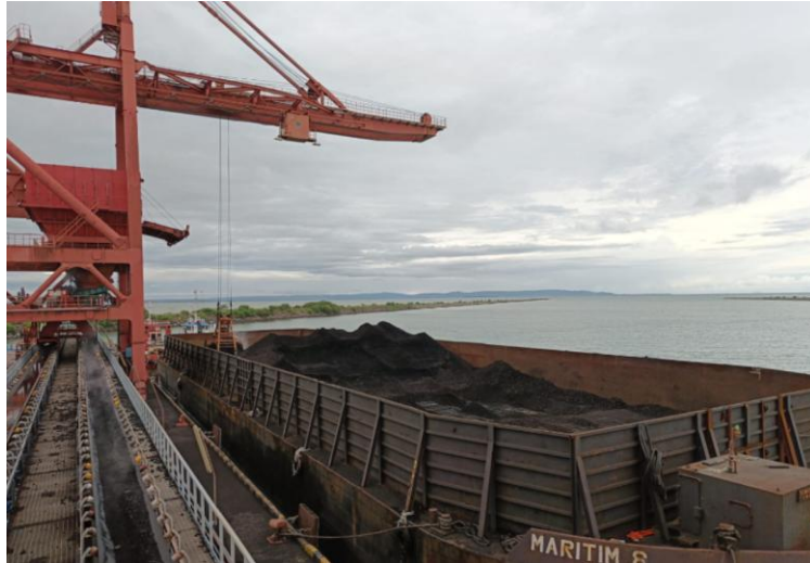
Gambar 2.4. Peralatan Ship Unloader dan Kapal Tongkang Batubara
