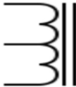
Gambar 2. 24 Skema Auto Transformator
