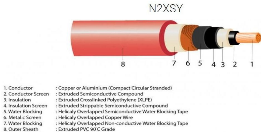
Gambar 2. 13 Konstruksi kabel power LV Trafo
