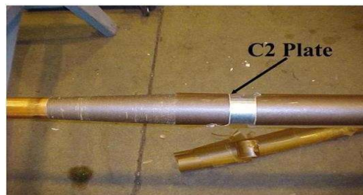
Gambar 8 konduktor Bushing dilapisi kertas isolasi
