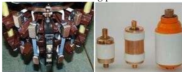
Gambar 17 Kontak Switching pada Diverter Switch
