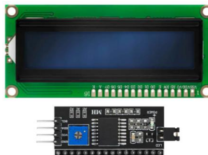
Gambar 2. 19 LCD 16×2 driven by HD44780 dengan I 2 C
