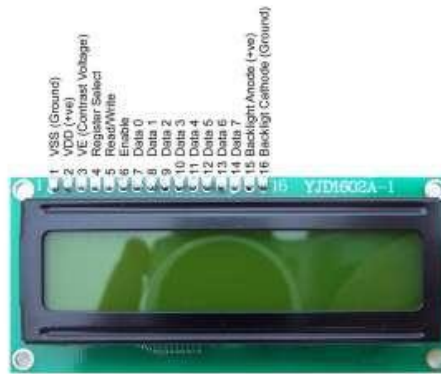
Gambar 2. 18 LCD 16×2 driven by HD44780 dengan pinmap
