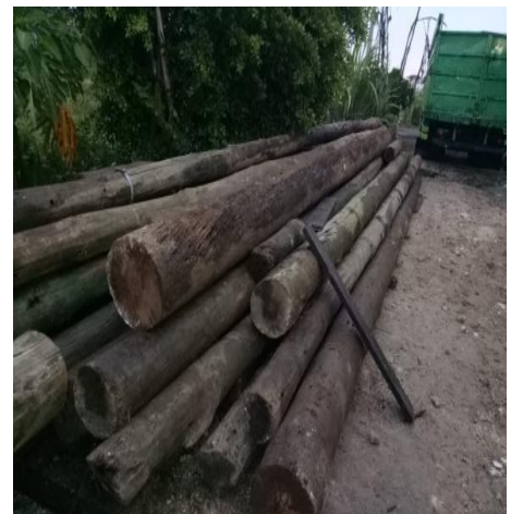
Gambar 7 Tiang Kayu Ulin
