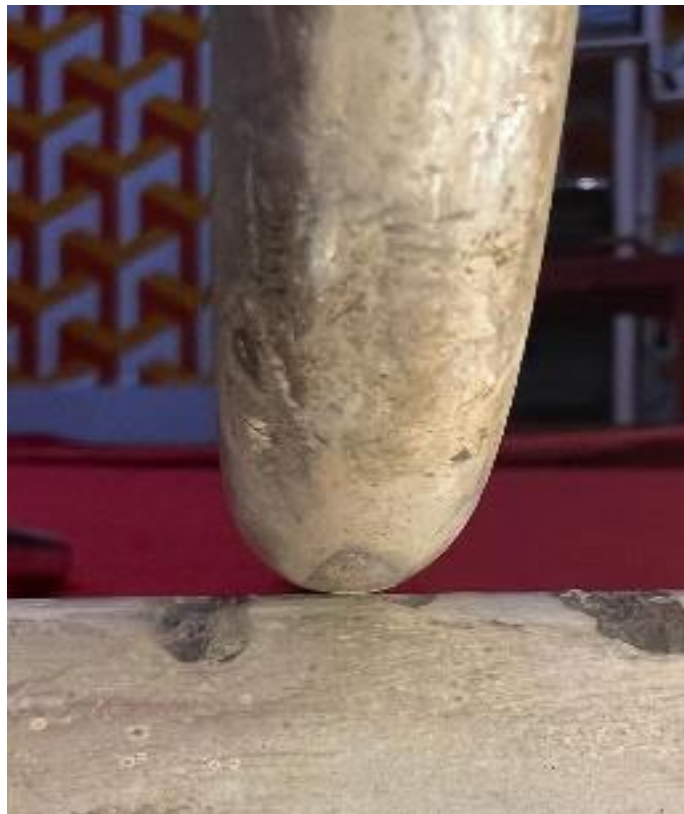
Gambar 2. 17 Titik Temu Kontak PMS ABB TIPE SGF170p100+1E Dilihat Dari Dekat
