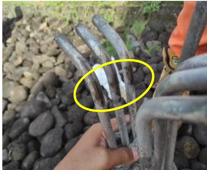
Gambar 2. 14 Kondisi Fisik Kontak Female Yang Mengalami Luka Gesek
