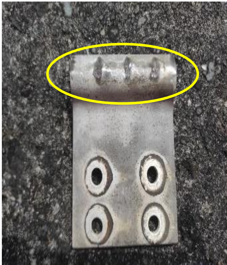
Gambar 2. 15 Kondisi Fisik Kontak Male
