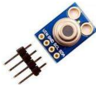
Gambar 4.4 Sensor IR MLX90614
