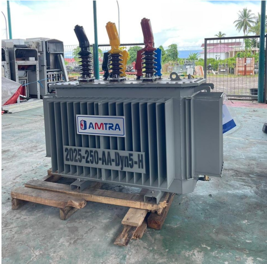
Gambar 2.23 Trafo Step Up
