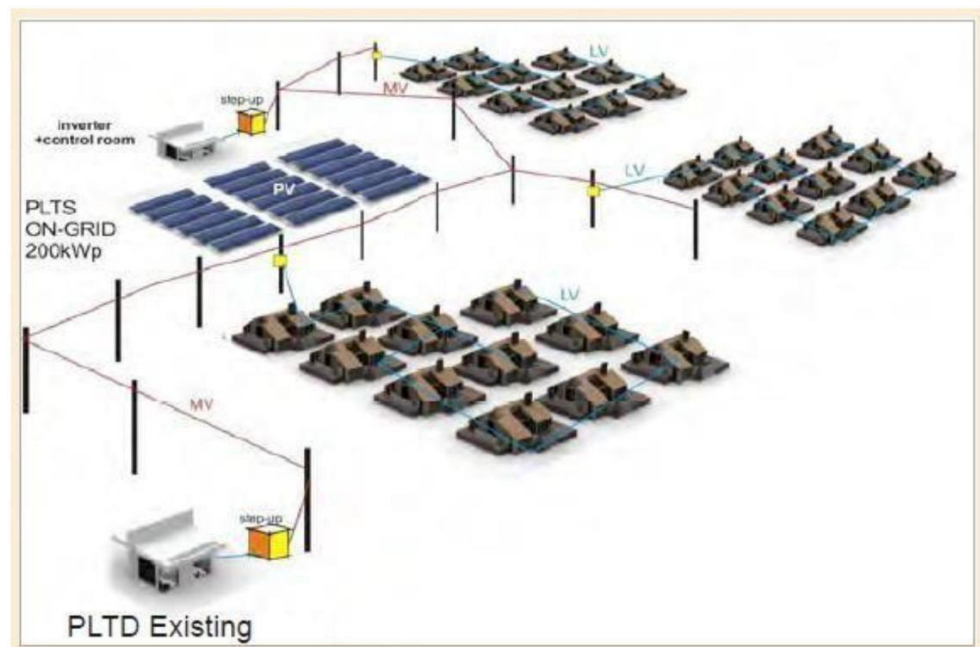
Gambar 2.14 Contoh PLTS hybrid, PLTS dengan PLTD
