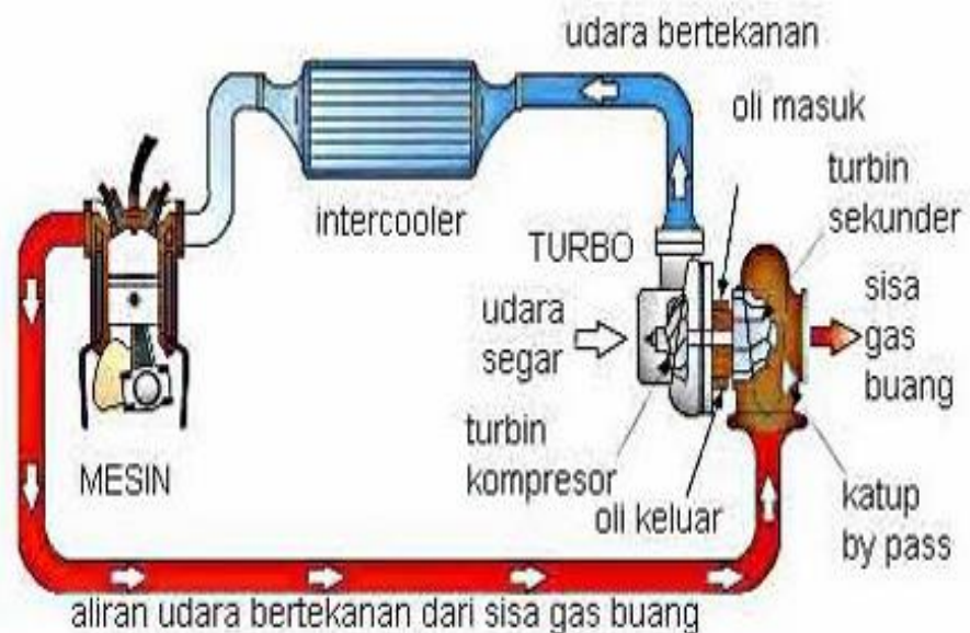
Gambar 2.7 Skema Kerja Turbocharger
