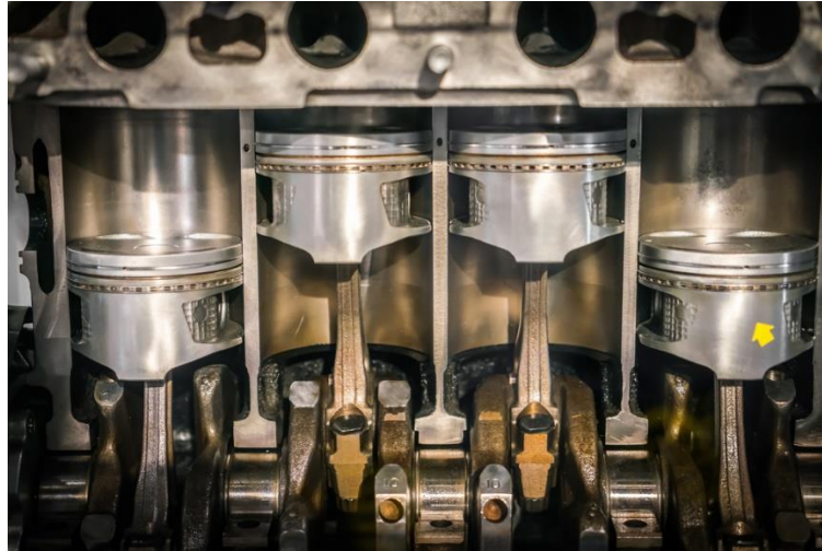
Gambar 2.1 Potongan blok silinder mesin diesel
