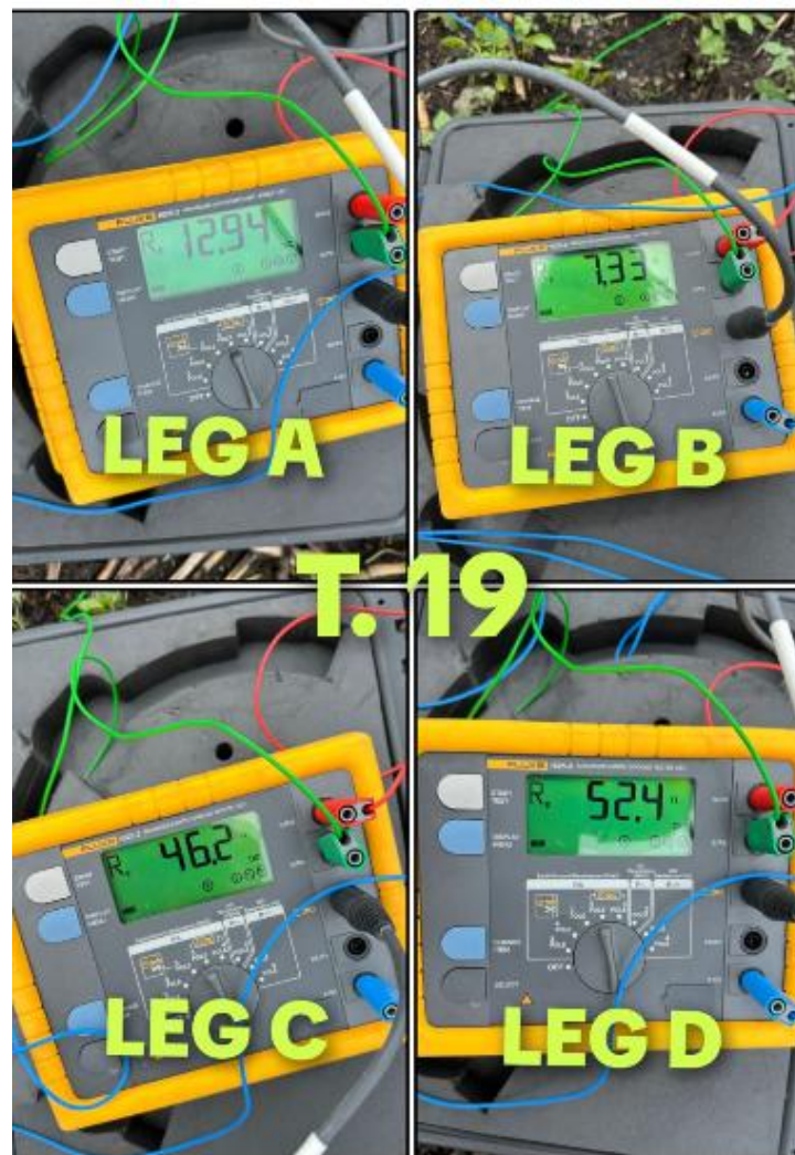
Gambar 4.9.5 Hasil Pengukuran Pentanahan
