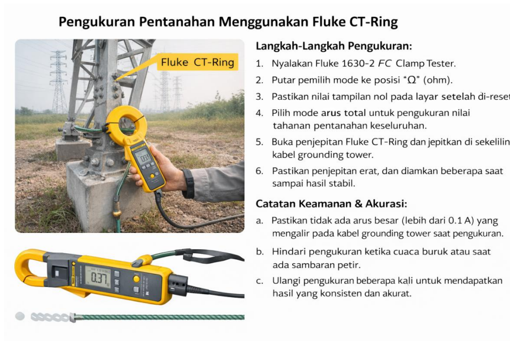
Gambar 4.8 Titik Pengukuran Menggunakan CT-Ring
