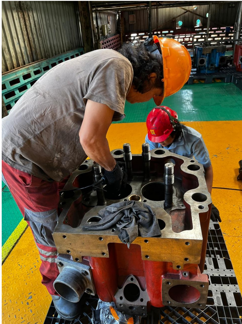
Gambar 2. 3 Pemeliharaan P3 (penggantian cylinder head)
