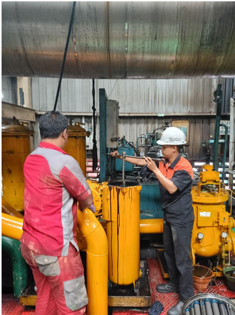
Gambar 2. 3 Pemeliharaan P2 (penggantian filter oli)
