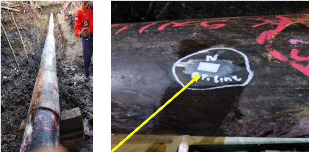
Gambar 2.3 Titik inspeksi posisi arah normal
