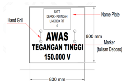
Gambar 2.14 Contoh tutup manhole LBP beton bertulang
