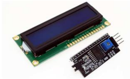
Gambar 2.7 LCD dan I2C[39]
