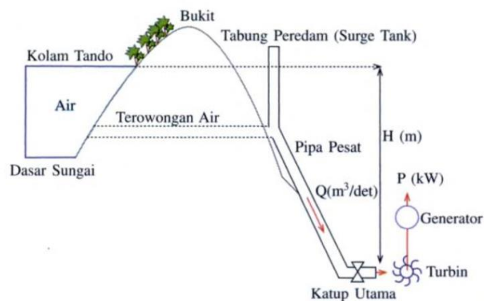
Gambar 2.1 Proses Konversi Energi dalam PLTA (Marsudi, 2005)
