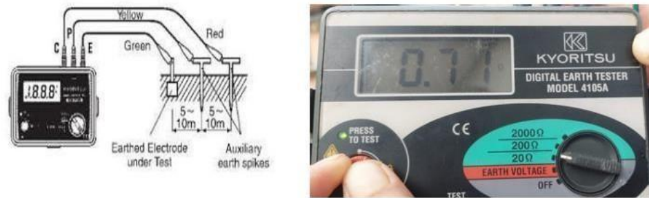
Gambar 2.5 Metode Pengukuran Pembumian 3 Titik dan Foto Hasil 1
