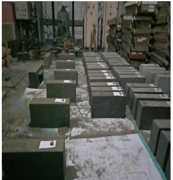
Perawatan Benda Uji Batako
