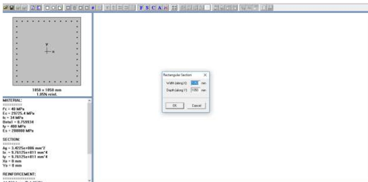
Input – section – rectangular digunakan untuk memasukan ukuran dimensi penampang kolom. Di masukan data dimensi kolom 1850 x 1850 mm.
