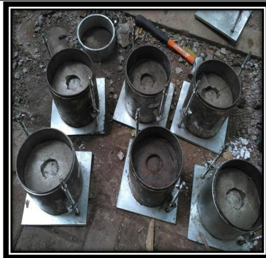
Hasil Sampel Pengujian CBR Setelah Ditumbuk 56 Kali Dengan Menggunakan *Rammer*.
