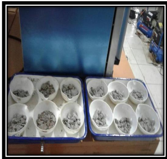
Hasil Pengujian Kadar Air dari Sampel Pengujian CBR.
