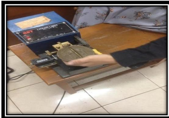
Pada Saat Menggores Lapisan Pasta Tanah Secara Tegak Lurus Dasar Cawan Dengan *Grooving Tool*.
