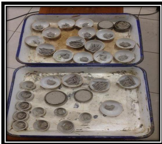
Hasil Sampel Pengujian *Plastic Limit* Setelah Dioven 24 Jam.
