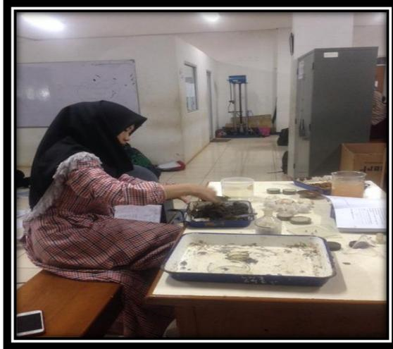
Pengujian *Plastic Limit* Dengan Cara Memilin-Milin Pasta Tanah Diatas Kaca Menggunakan Telapak Tangan Hingga Membentuk Rol Panjang.
