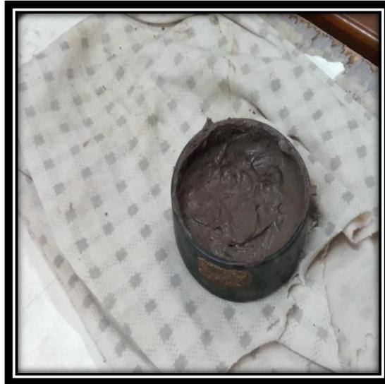
Pengujian *Shrinkage* Menggunakan Gelas Susut.
