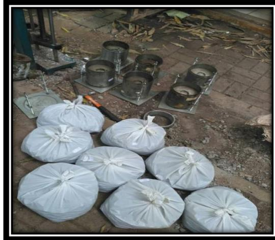
Persiapan Sampel Tanah Pengujian CBR (*California Bearing Ratio*) Untuk Pemeraman 0 Hari dan 7 Hari.
