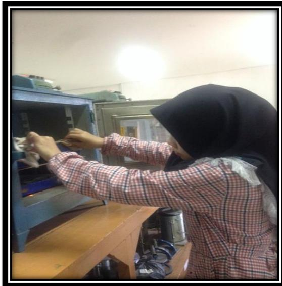
Pada Saat Mengeluarkan Sampel Tanah Penujian *Plastic Limit* Dari Oven.
