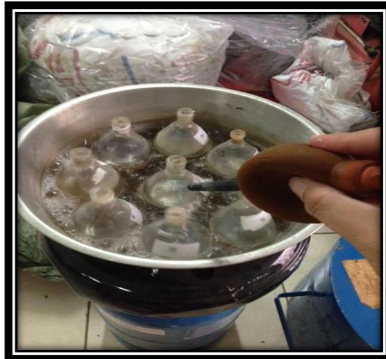
Pada Saat Perebusan Pycnometer Menggunakan *Blue Gas*.
