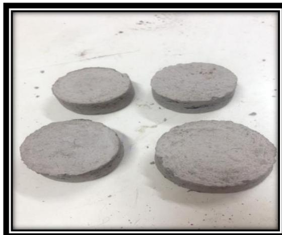
Hasil Sampel Pengujian *Shrinkage* Setelah Dioven 24 Jam.
