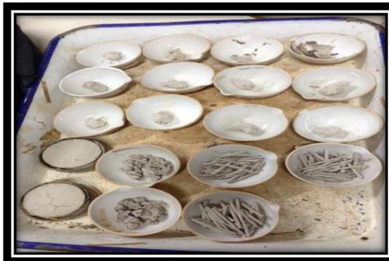
Hasil Pengujian *Liquid Limit* Setelah Dioven 24 Jam.
