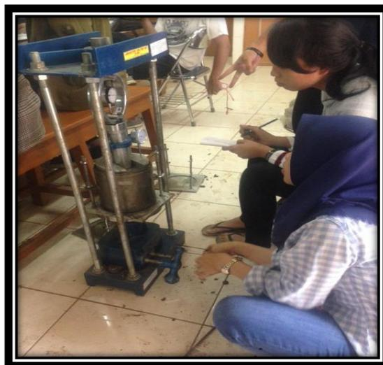
Pada Saat Pembacaan Nilai CBR Menggunakan Alat *Dial Gauge* Pada Penetrasi yang Ditentukan.
