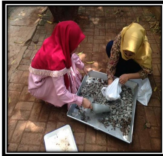
Pada Saat Pencampuran Sampel Tanah Dengan Semen Secara Homogen.
