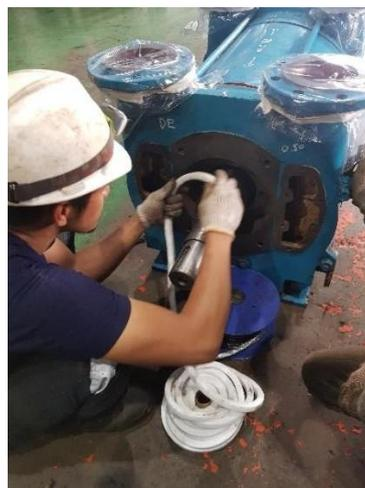
Gambar 4.14 Pemasangan *Gland Packing*
