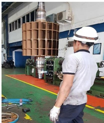
Gambar 2.21 proses pemuaiian *bearing*
