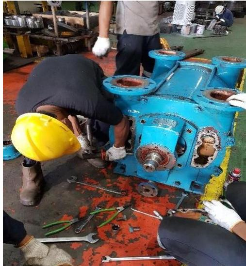
Gambar 2.20 pembongkaran pompa vakum
