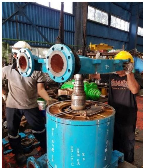
Gambar 4.5 Pengangkatan Cover Bagian DE
