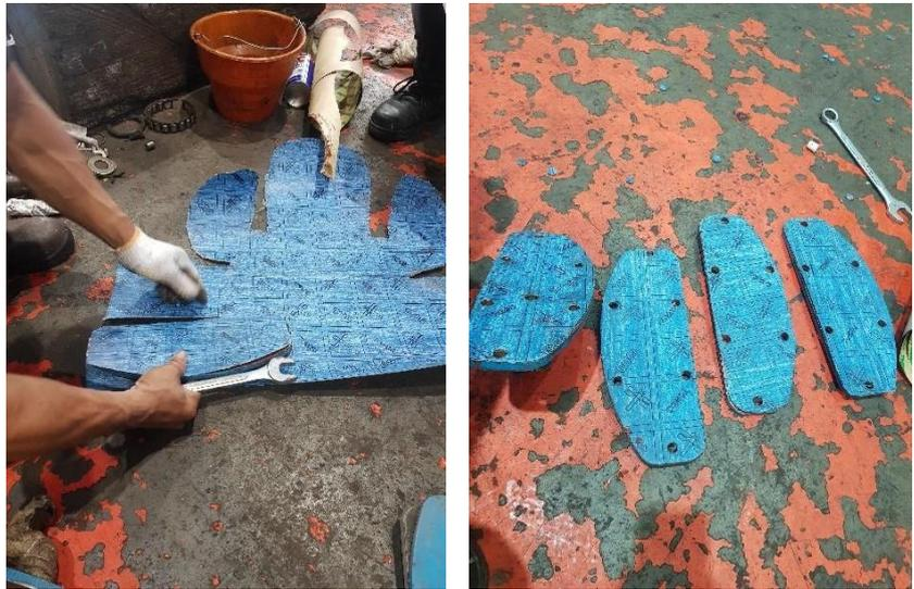
Gambar 4.17 Pemasangan Packing
