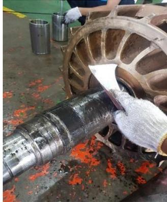
Gambar 4.9 Membersihkan Bagian Shaft Sleeve
