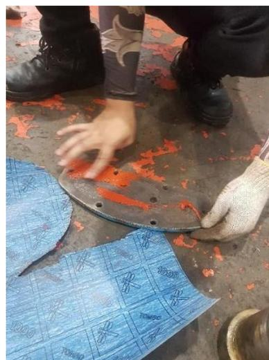
Gambar 4.16 Menggunakan lem *high temperature*
