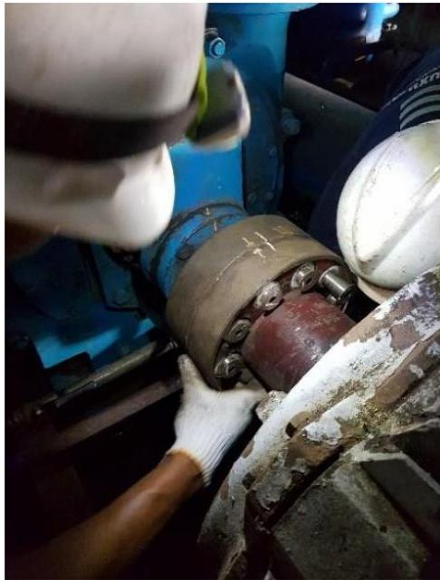
Gambar 4.1 Pelepasan Baut Kopling
