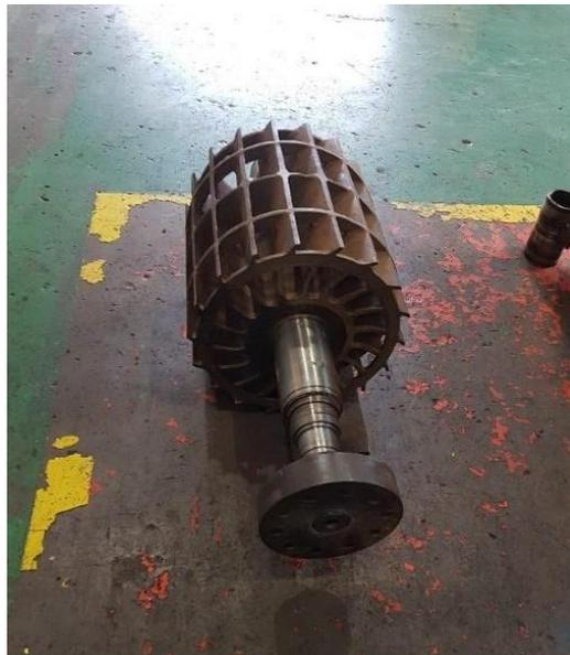
Gambar 4.8 Shaft Impeller
