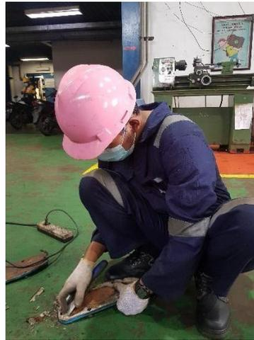
Gambar 4.15 Membersihkan plat penutup casing
