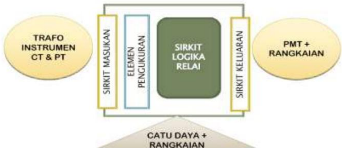
Gambar 2.3 Komponen Utama Relai Proteksi
