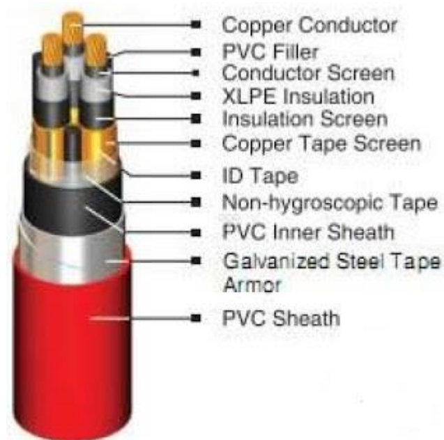
Gambar 2.5 Konstruksi kabel tegangan menengah inti tiga
