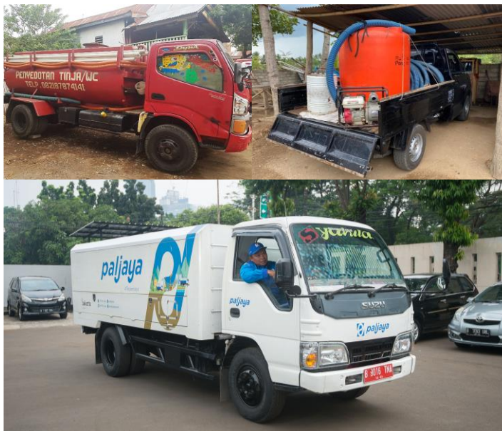
Gambar 15. Berbagai jenis kendaraan penyedot lumpur (sumber: UNICEF and PD PAL Jaya).
