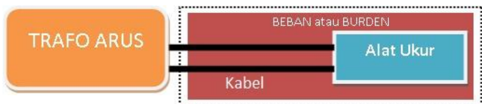
Gambar 2.8 Ilustrasi Dari Burden pada Trafo Arus
