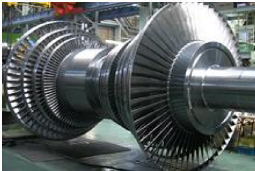
Gambar 4. 12 Rotor turbin PLTP kapasitas 55000 kW
