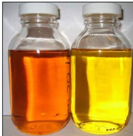
Gambar 2.5 Warna pada Minyak Isolasi Transformator
