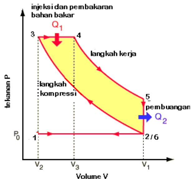
Gambar 2. 2 Diagram p-v untuk mesin Diesel 4 langkah
