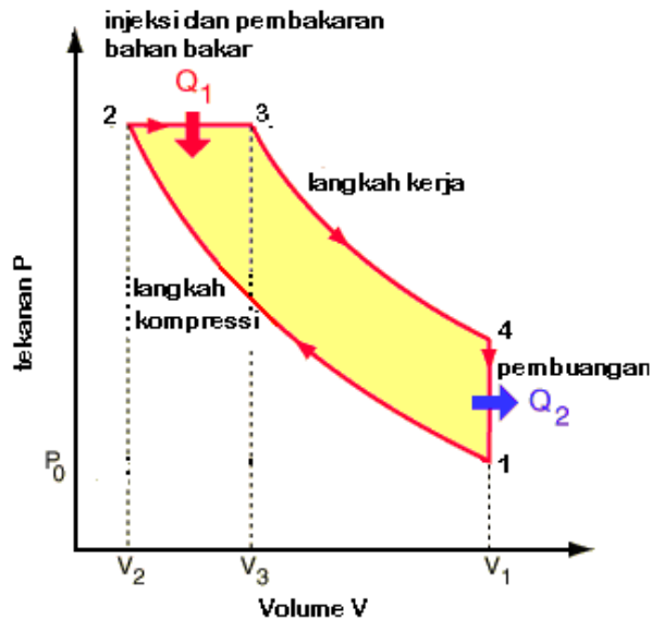
Gambar 2. 4 Diagram p- v untuk mesin Diesel 2 langkah
