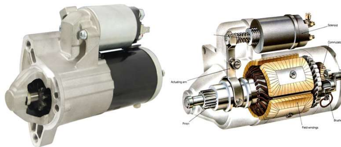
Gambar 2.11 Konstruksi Starter Motor
